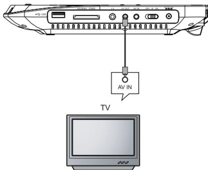
Соедините аудио/видео кабелем аудио/видео выход AV OUT проигрывателя с аудио/видео входом телевизора. Переведите телевизор в режим AV, чтобы начать просмотр с проигрывателя.
