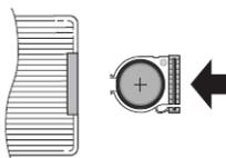
Установите в держатель элемент питания, как показано на рисунке задвиньте его обратно в отсек пульта ДУ.
