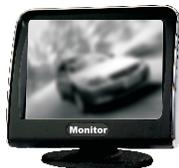
Размытое изображение. Камера испачкана, протрите камеру.
